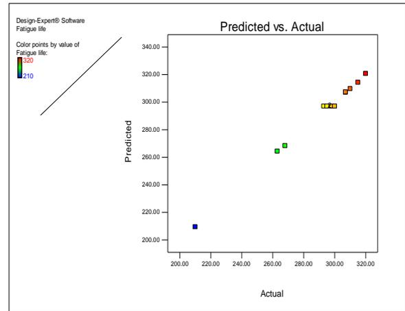
Fig. 4. Predicted versus actual fatigue life data for comparison.
