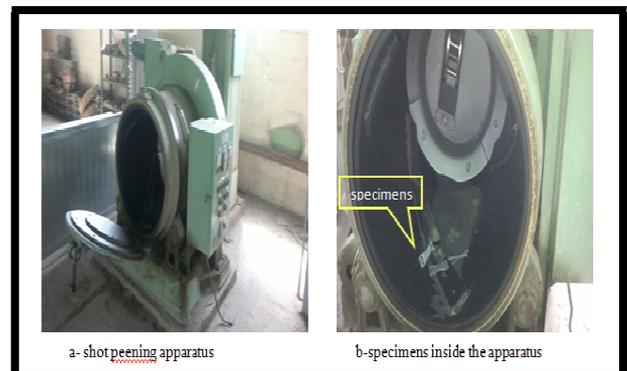
Fig. 4. Shot peening apparatus.
