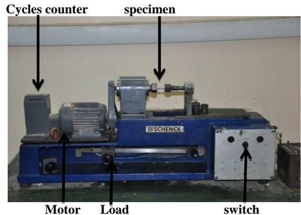
Fig. 2. Fatigue test machine.
