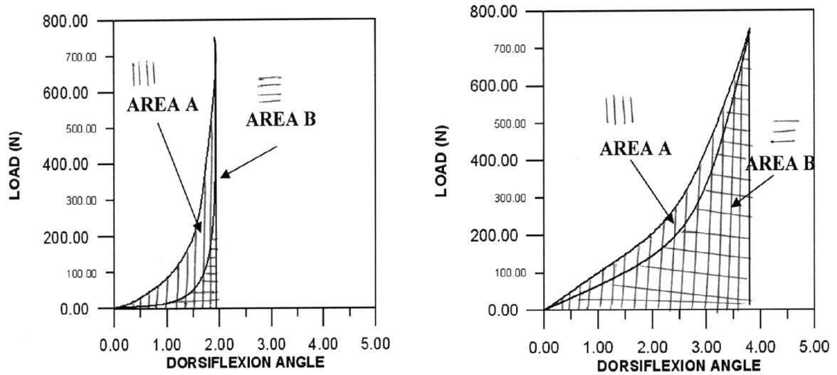
FIGURE( 7 ) HYSTERICIS LOOP FOR : A – SACH FOOT , B- NEW FOOT
